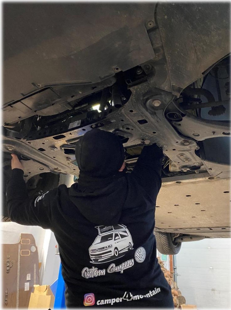
Montaż zbiornika paliwa
